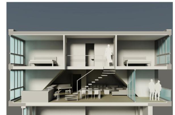
Schnitt: Vorentwurf Bestandsdach mit Dachaufbauten
